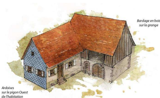
Ardoises sur le pignon Ouest de l'habitation Bardage en bois sur la grange Source : Eco-renover – Parc des Vosges du Nord
